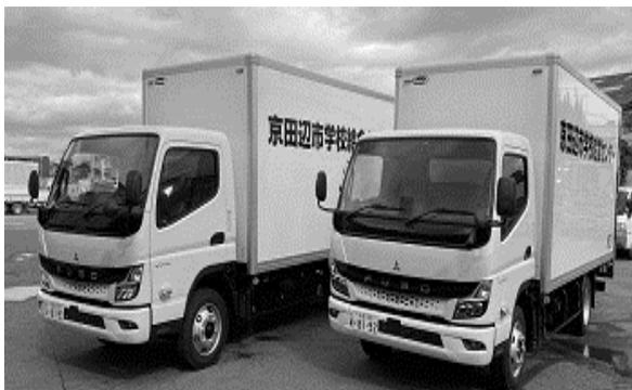
学校給食センターで調理した給食は、関西で初めてとなる給食配送専用のEVトラックで各中学校へ配送します。静かな走行により授業への影響に配慮しています。
